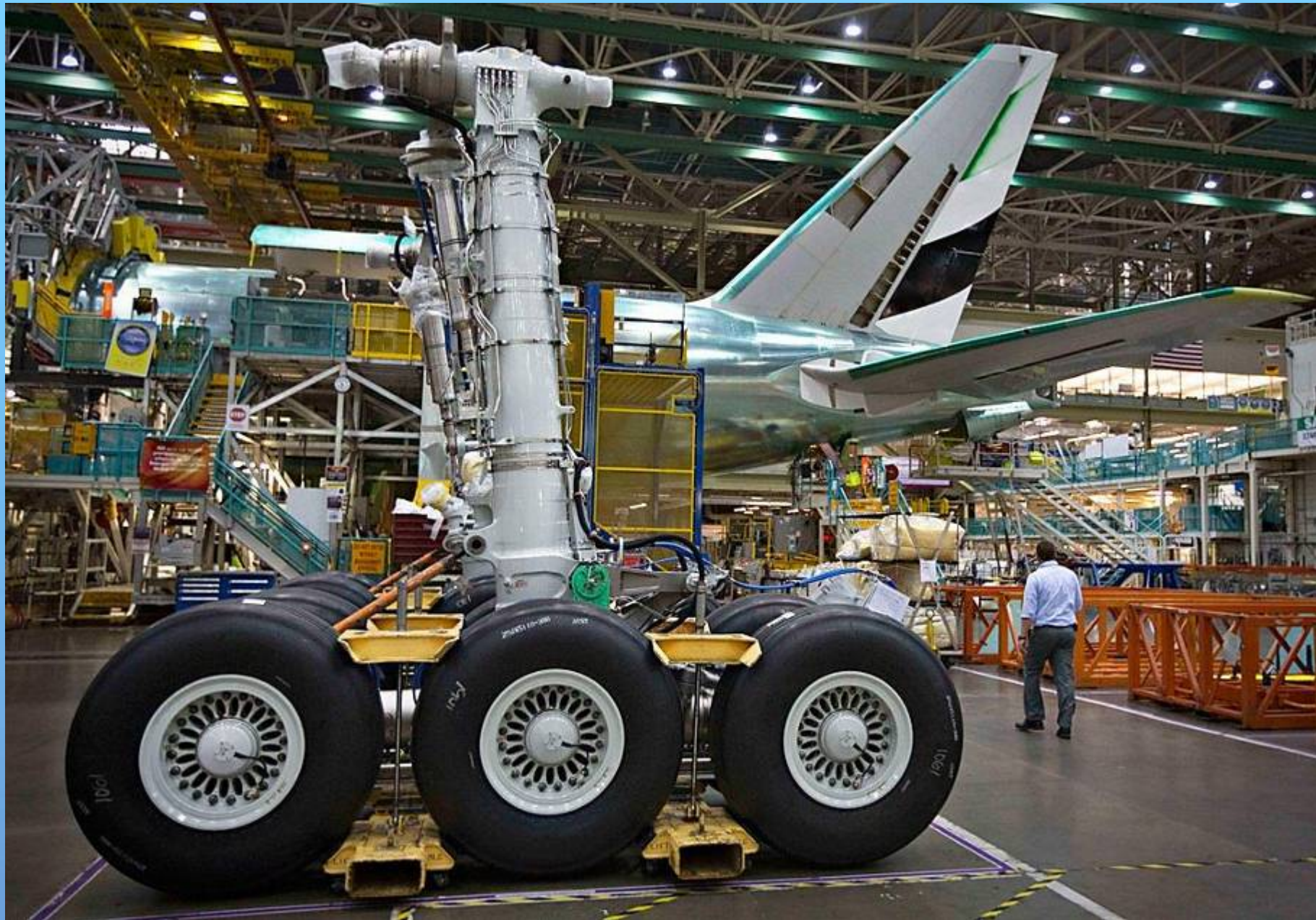
В одном из цехов монтируют шасси для боинга-777 Эверетт
