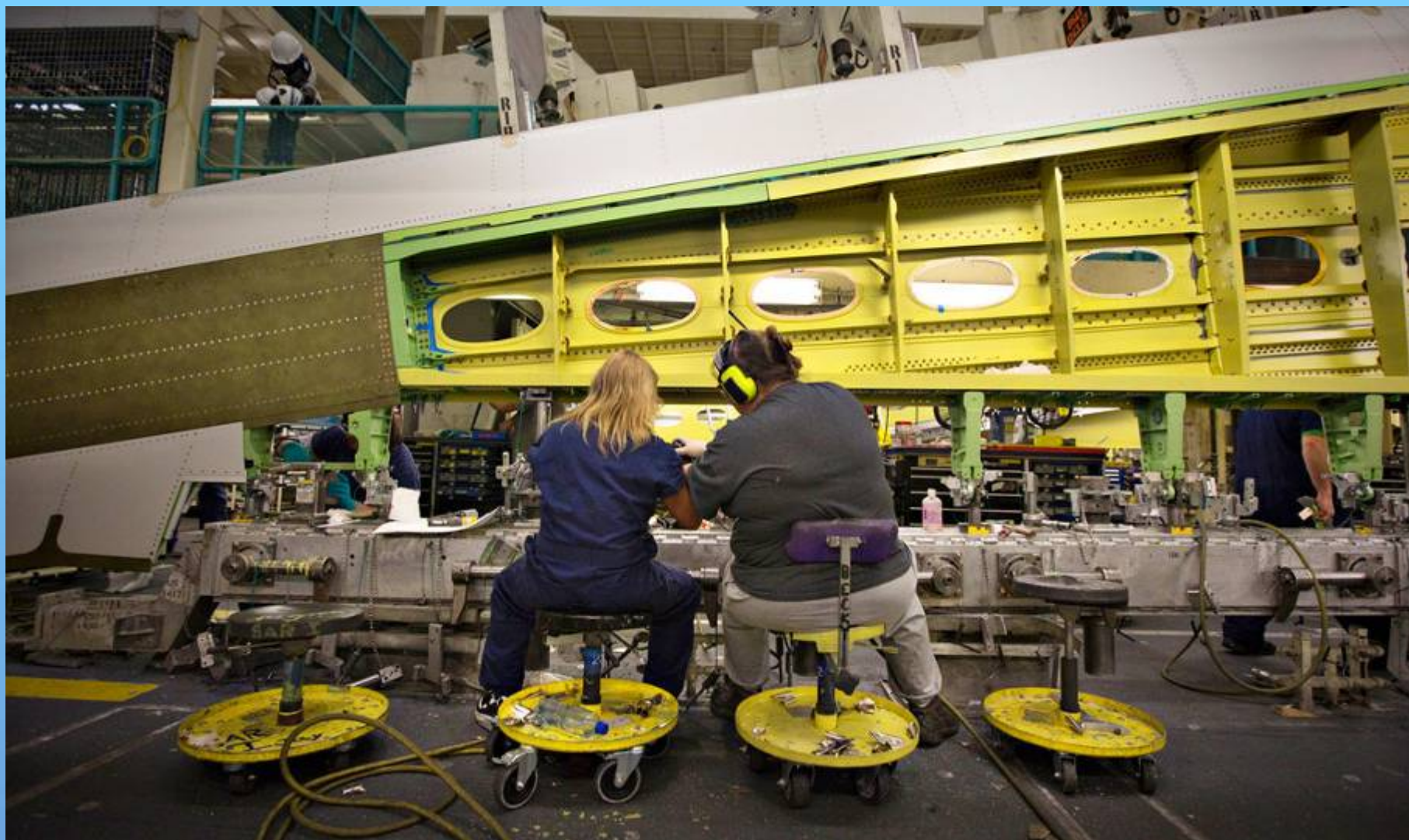
Инженеры работают над крылом для боинга-777 Эверет
